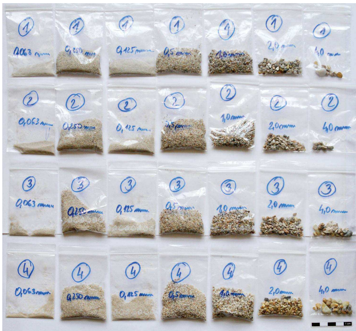
Obr. 3: Fotodokumentace celých objemů jednotlivých frakcí plniva (kromě < 0,063 ) všech čtyř vzorků
